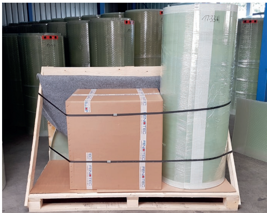
Die Einzelteile eines Tanks mit 3.100 Litern Volumen passen auf eine Palette
